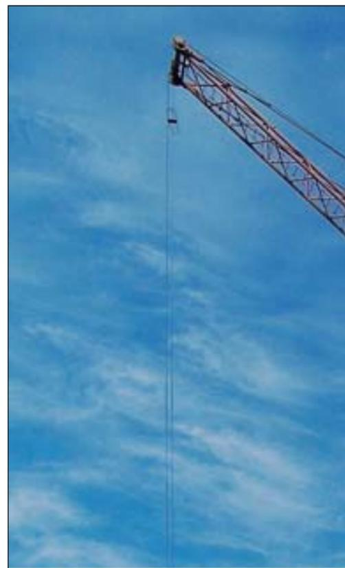
КБ-100 модель крана. Ереванский завод конструкция, у нее быстро кончается конструкция трубчато-коробчатая, допустим, дельные, они гниют внутри очень быстро.
