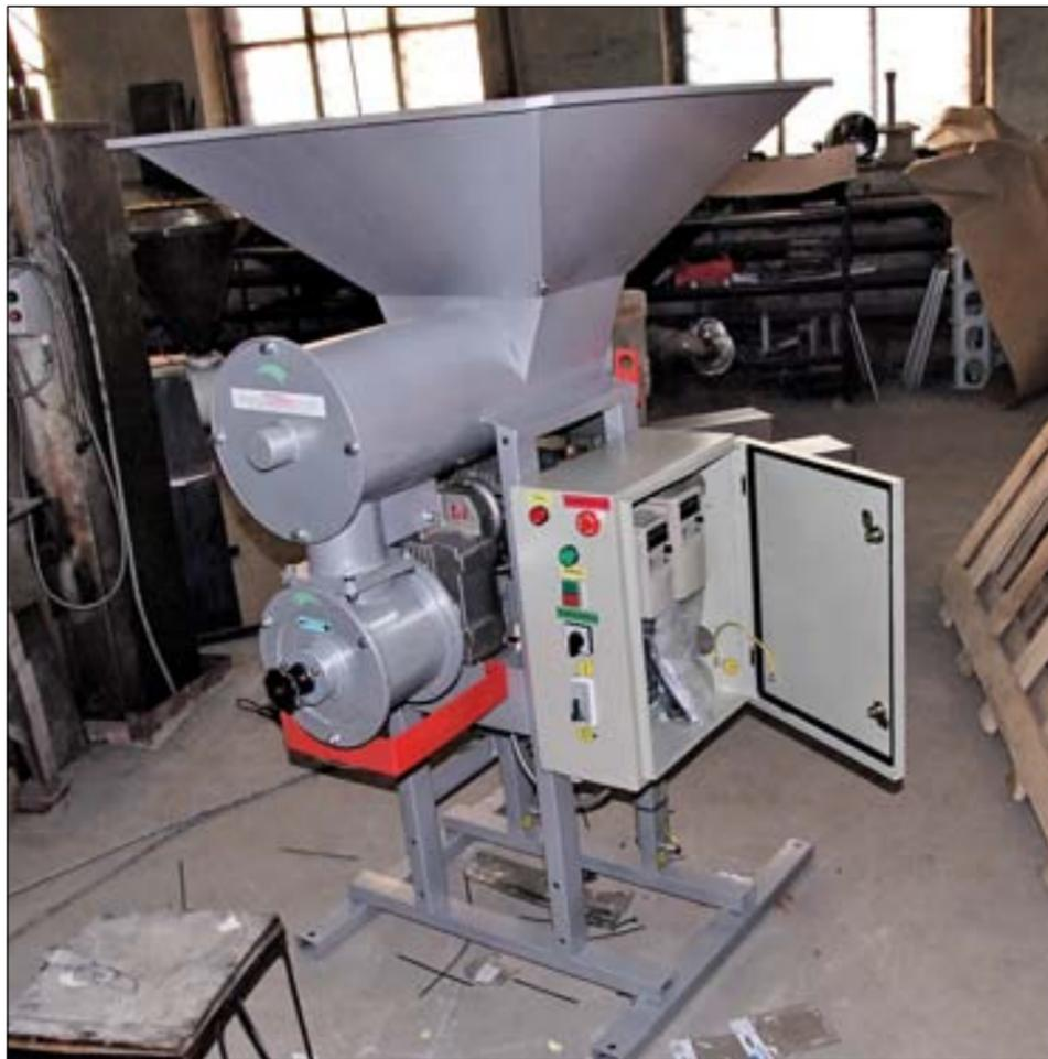
Шнековый тестоделитель “Кузбасс” практически не уступает вакуумному, но намного дешевле. Качество работы с тестом достигается за счет преобразователей, которые управляют головкой и шнеком
