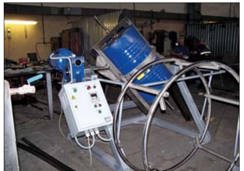
Вверху: мешалка типа "пьяная бочка" под сменную тару, внизу: так называемый Y-образный смеситель - основной тип оборудования, оснащаемый весперами.
