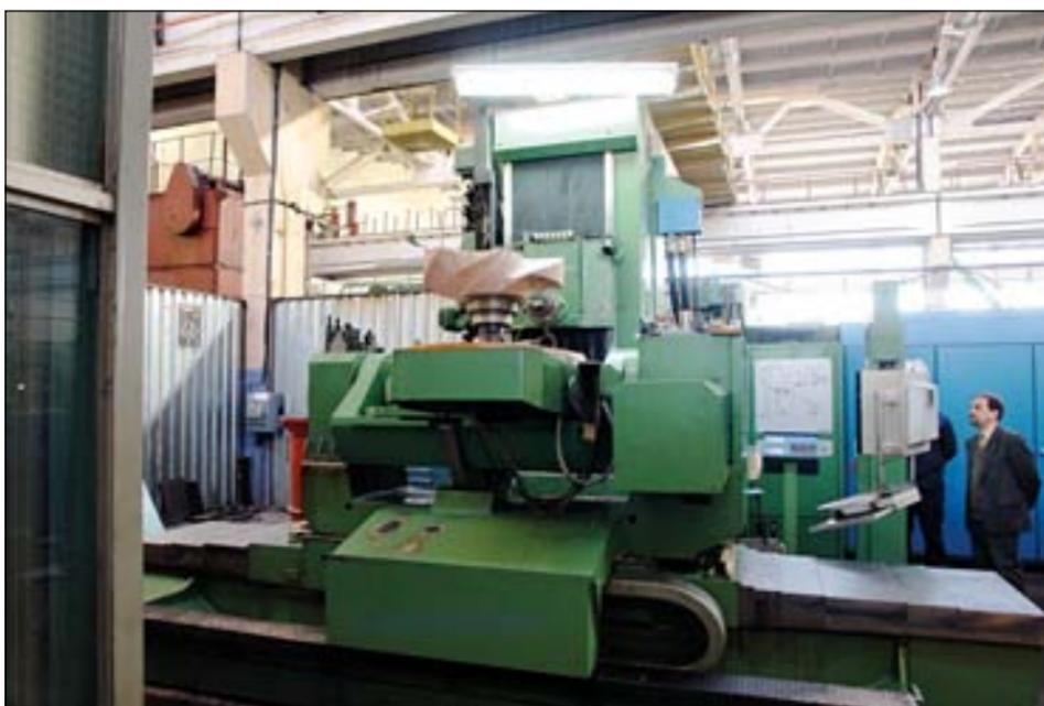
Изготовление модели гребного винта для отливки. Справа директор филиала опытного завода "Вега" Файнгерц Л. Е.
